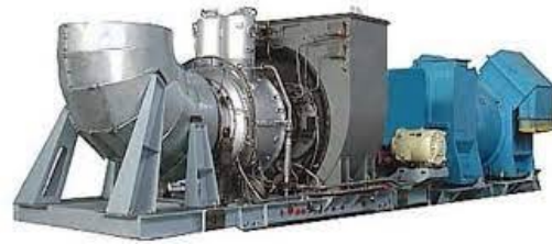
Figur 9. UGT2500 gasturbin från Zorya Mashproekt (2,5 MWe).
